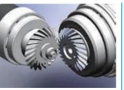
螺旋傘型齒輪採用高級合金鋼為 材質,在滾齒加工及熱處理後, 達到高精準度咬合點及低背隙、 低噪音。
