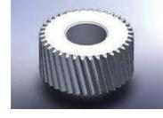
齒輪材質選用高級合金鋼,獨特熱處理至最佳硬 度,兼具表面硬度及心部韌度,並經過齒型研磨 加工,以獲得最佳的精度、高耐磨耗及高耐衝擊 韌性
